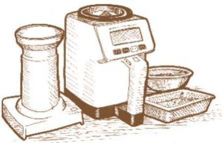
Figura 3.13 Medidor de humedad portátil
