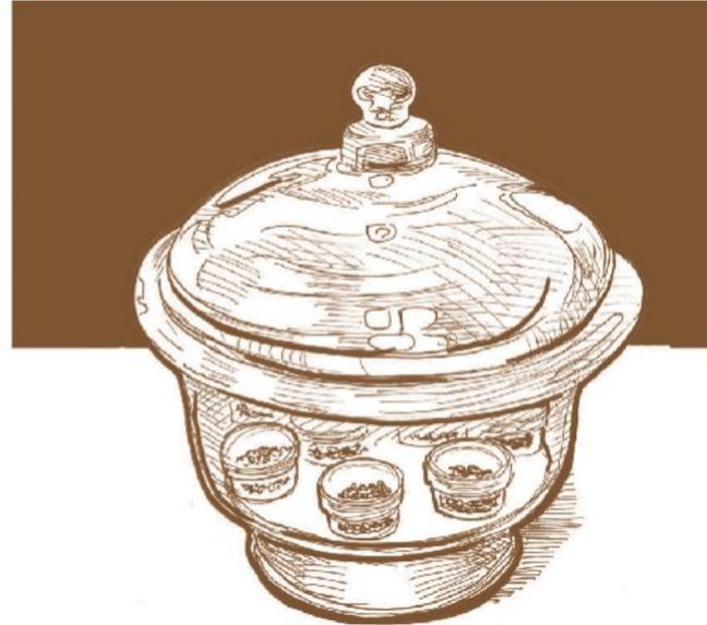
Figura 3.12 Análisis de humedad. Secando semillas en un horno (izquierda) y poniéndolas a enfriar en un desecador (derecha)
